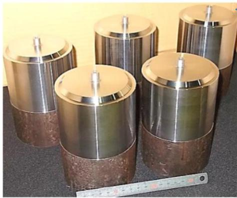
S45C(機械構造用炭素鋼)を切断後、溶射前形状に旋盤加工
